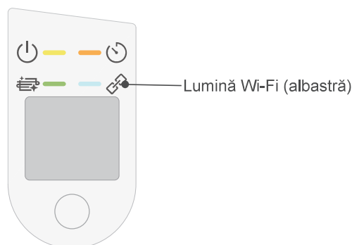
Indicațiile de pe unitatea de interior: LED Wi-Fi
